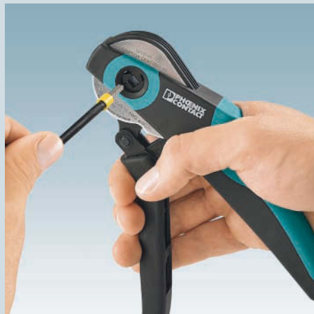
CRIMPFOX CENTRUS обжимные клещи для изолированных, неизолированных и двойных гильзовых кабельных наконечников сечением 0.14 – 6 мм 2 или 0.14 – 10 мм 2 .
